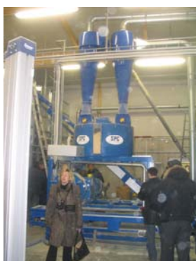
Предприятие вблизи Стокгольма. Небольшое производство гранул, где установлен пресс шведской фирмы SPC, производительность до 500 кг пеллет в час.
